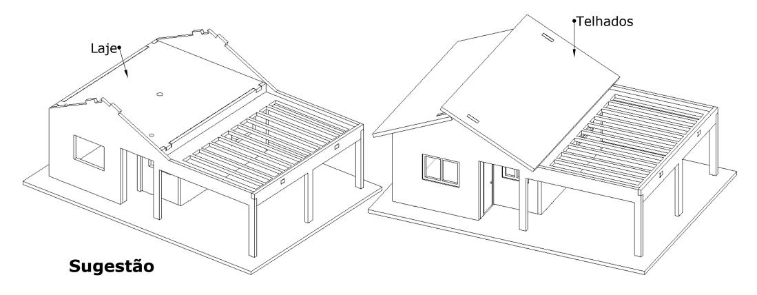
A Laje e o telhado foram projetados para ficar soltos e facilitar a manutenção.
