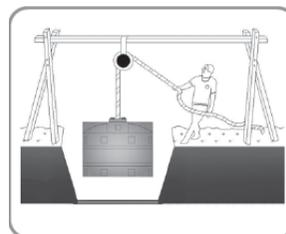
Comece a instalação da cisterna utilizando, se necessário, uma roldana apoiada sobre uma estrutura de madeira e uma corda. Ao baixar a cisterna, certifique-se de que não haja pedras ou outros objetos entre a base da cisterna e a base de concreto.
