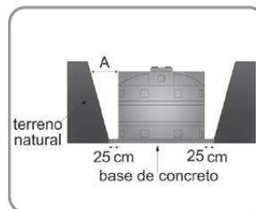
Sugerimos que a profundidade mínima de escavação seja a altura da cisterna mais 0,20 m, levando em conta a espessura da base de concreto situada na parte inferior da escavação.
