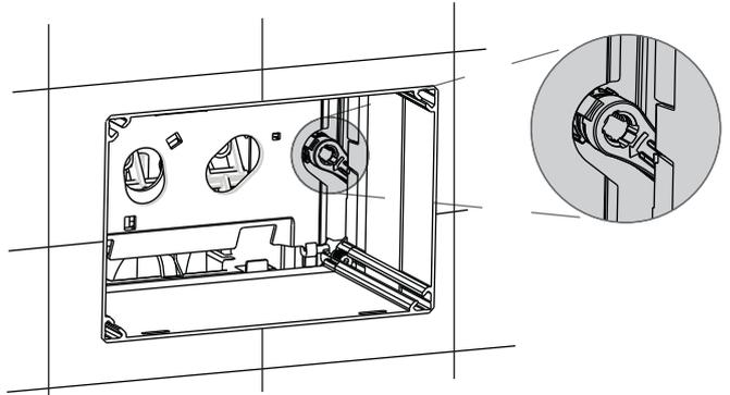
**3** Se a parede tiver menos de 20mm deve retirar a placa de proteção e guardar.
