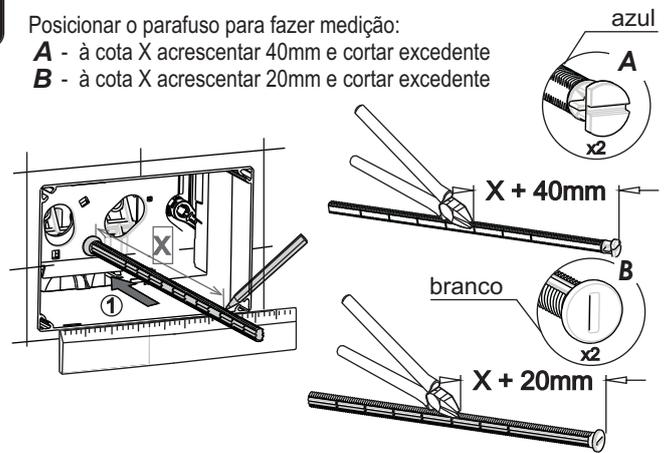
**5** Aperte os parafusos conforme a figura
