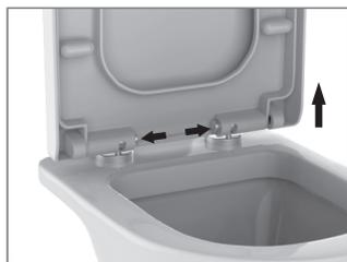
**Passo 5:** Retorne a apertar os parafusos de fixação (2) e garantir assim a perfeita fixação do assento, coloque os acabamentos das bases (3);
