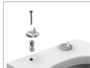
**Passo 2:** Encaixe o assento nas bases de fixação (1) utilizando os furos de encaixe (5) até ouvir o "click";
