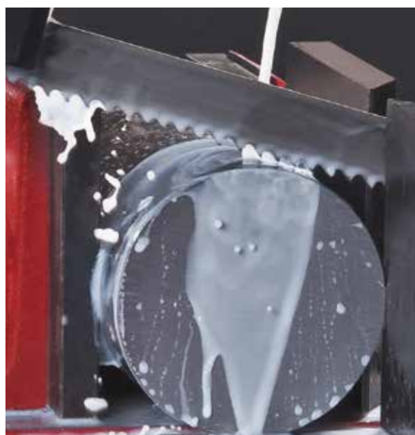
Comece a cortar o material com um avanço de corte reduzido
