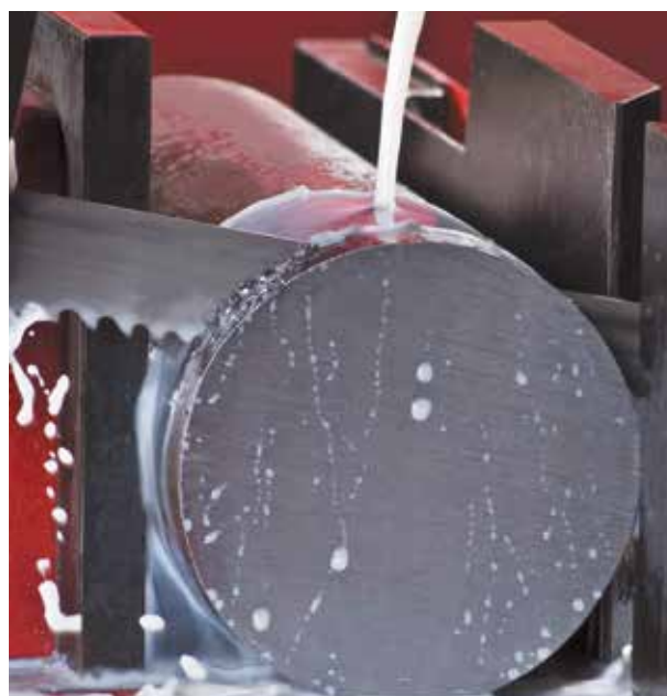
Após o amaciamento (20 a 30 minutos), aumente o avanço gradualmente até alcançar o avanço de corte recomendado
