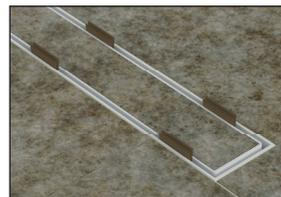
**Passo 4:** Faça o acabamento com o piso desejado respeitando a altura máxima do Perfil.
