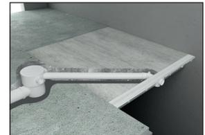
**Passo 3:** Instale o produto conforme especificado no seu projeto, lembrando que no momento da concretagem o Perfil deve estar com o Porta Piso encaixada.
