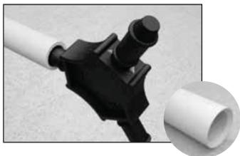
**Obs.:** O chanfro feito pelo calibrador/chanfrador facilita o encaixe do tubo na conexão.
