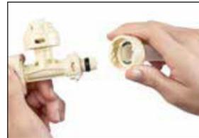
**Passo 4:** Remova o acoplador do tubo, empurrando o tubo no sentido do acoplador, até a trava metálica ser expelida do tubo.
