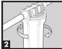
2 Desenrosque o copo do filtro. Utilize a chave se necessário (segure com uma das mãos o filtro, para não danificar a tubulação).
