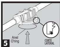
5 Observe se o anel o'ring utilizado para a vedação do filtro está devidamente alojado na tampa (cód. 2237- 70B).
