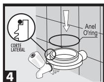
Observe se o anel o'ring utilizado para a vedação do filtro está devidamente alojado na tampa (cód. 2237-70B). Não utilize fita veda rosca na tampa do filtro.
