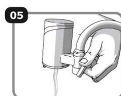
**05** Abra a torneira revezando entre a água filtrada (para cima) ou sem filtração (para baixo) para ver se não existem vazamentos.
