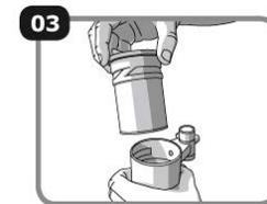
**03** Retire o refil saturado e coloque o novo refil.
