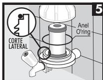
**5** - Verifique na tampa do filtro as indicações IN e OUT. IN indica onde será ligada a entrada da água e OUT, a saída da água filtrada.
