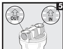
**5** Verifique na tampa do filtro as indicações IN e OUT. IN indica onde será ligada a entrada de água e OUT, a saída da água filtrada.
