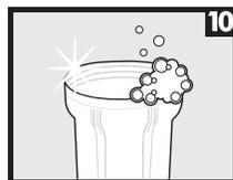
**10** Faça rotineiramente uma limpeza do copo do filtro. Utilize apenas água e sabão biodegradável. Evite materiais abrasivos.
