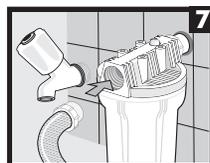
**7** Encaixe a torneira no aparelho (OUT), ou a tubulação que dará seqüência a instalação (em caso de bebedouros, máquinas de café, etc.)
