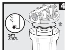
**4** Observe se o anel o'ring utilizado para a vedação do filtro está devidamente alojado na tampa (cód. 2237- 70B).
