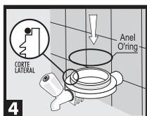
4 Observe se o anel o'ring utilizado para a vedação do filtro está devidamente alojado na tampa (cód. 2237-70B). Não utilize fita veda rosca na tampa do filtro.
