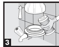
3 Com uma luva, retire o elemento filtrante cheio de impurezas. Lave a tampa e o copo do filtro com água e sabão biodegradável.
