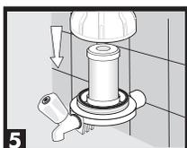
5 Encaixe o elemento filtrante na tampa ou copo (conforme posição do copo). Enrosque o copo de volta na tampa. Ligue o registro geral.
