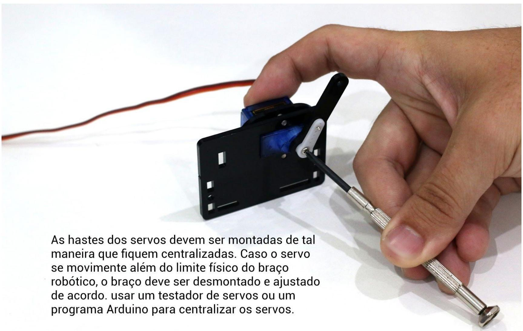
As hastes dos servos devem ser montadas de tal maneira que fiquem centralizadas. Caso o servo se movimente além do limite físico do braço robótico, o braço deve ser desmontado e ajustado de acordo. usar um testador de servos ou um programa Arduino para centralizar os servos.
