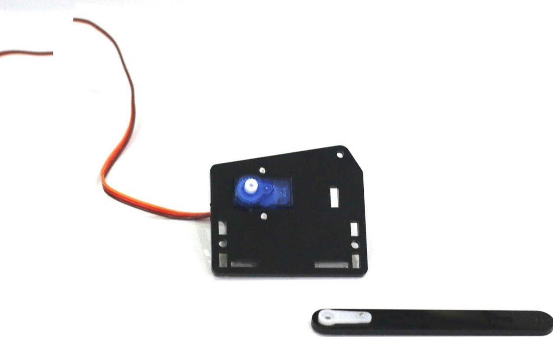
As hastes dos servos devem ser montadas de tal maneira que fiquem centralizadas. Caso o servo se movimente além do limite físico do braço robótico, o braço deve ser desmontado e ajustado de acordo. usar um testador de servos ou um programa Arduino para centralizar os servos.
