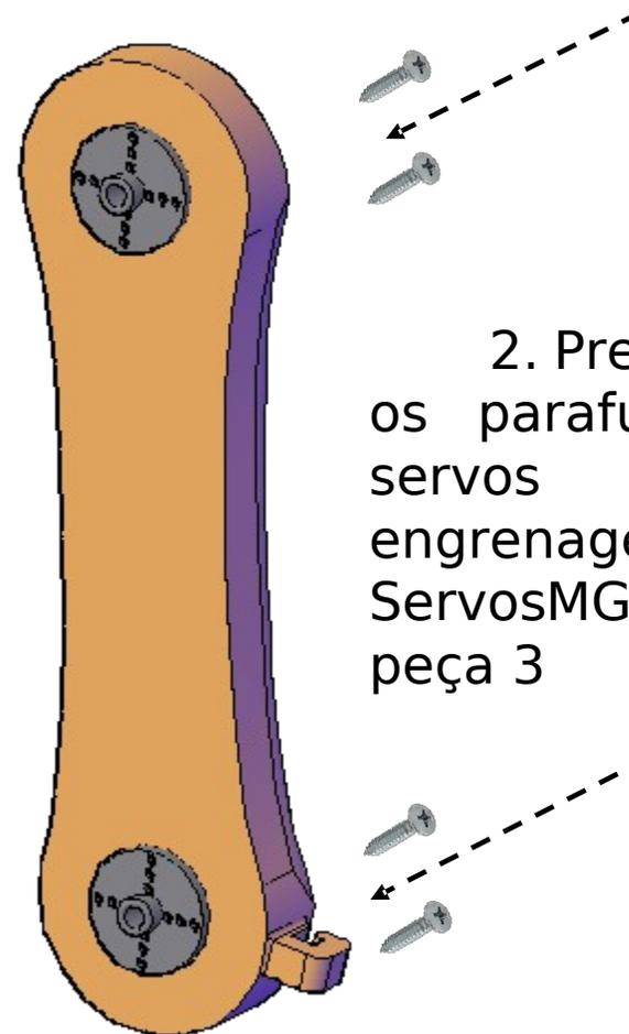
2. Prenda com os parafusos dos servos as engrenagens dos ServosMG996R na peça 3
