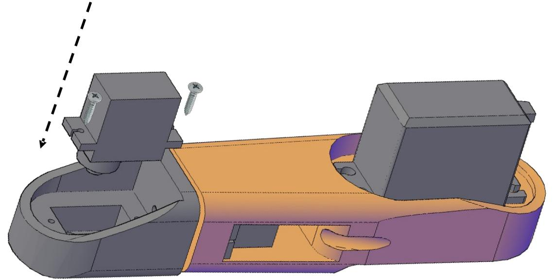
2. Coloque o Servo SG90 na peça 6
