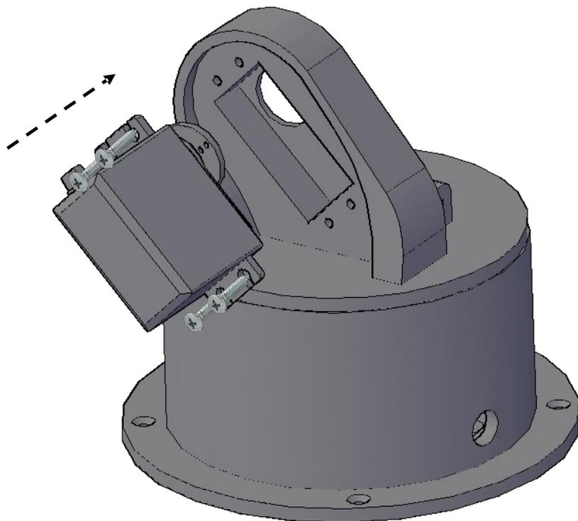
1. Coloque o Servo MG996R na peça 2
