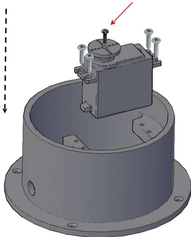
1. Prenda o Servo MG996R com os 4 parafusos na peça 1 e coloque o parafuso preto que fixa a engrenagem do servo
