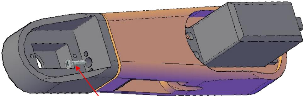
1. Após alinhar o Servo SG90 da peça 5 com a peça 6 coloque o parafuso que aperta a engrenagem do servo
