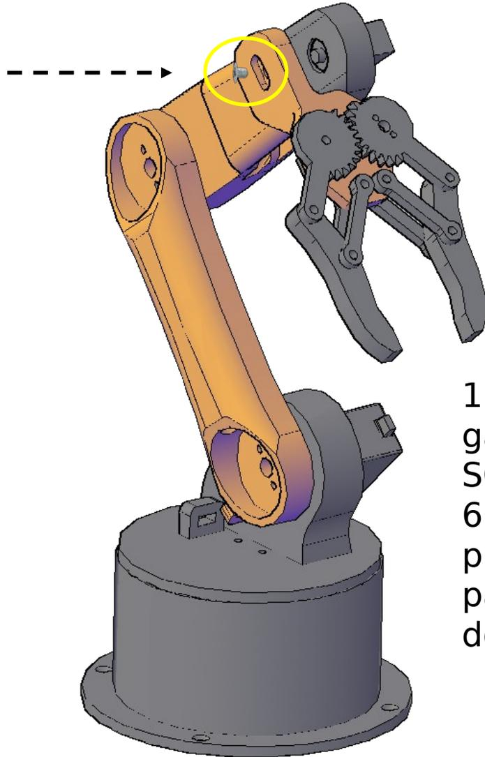
1. Coloque a garra no Servo SG90 da peças 6 e após alinhar prenda com o parafuso menor do servo SG90
