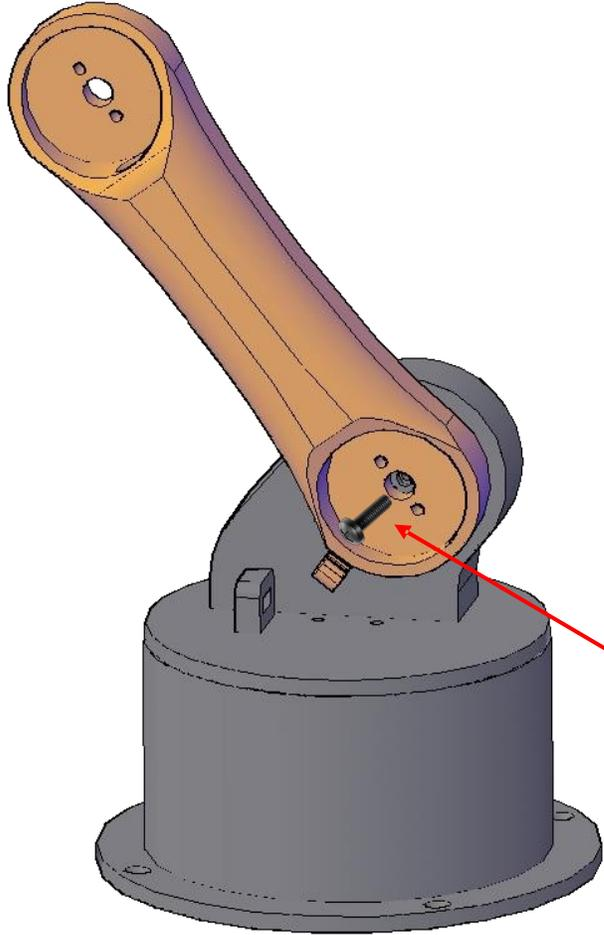
1. Após alinhar o Servo da peça 2 com a peça 3 coloque o parafuso preto do Servo MG996R
