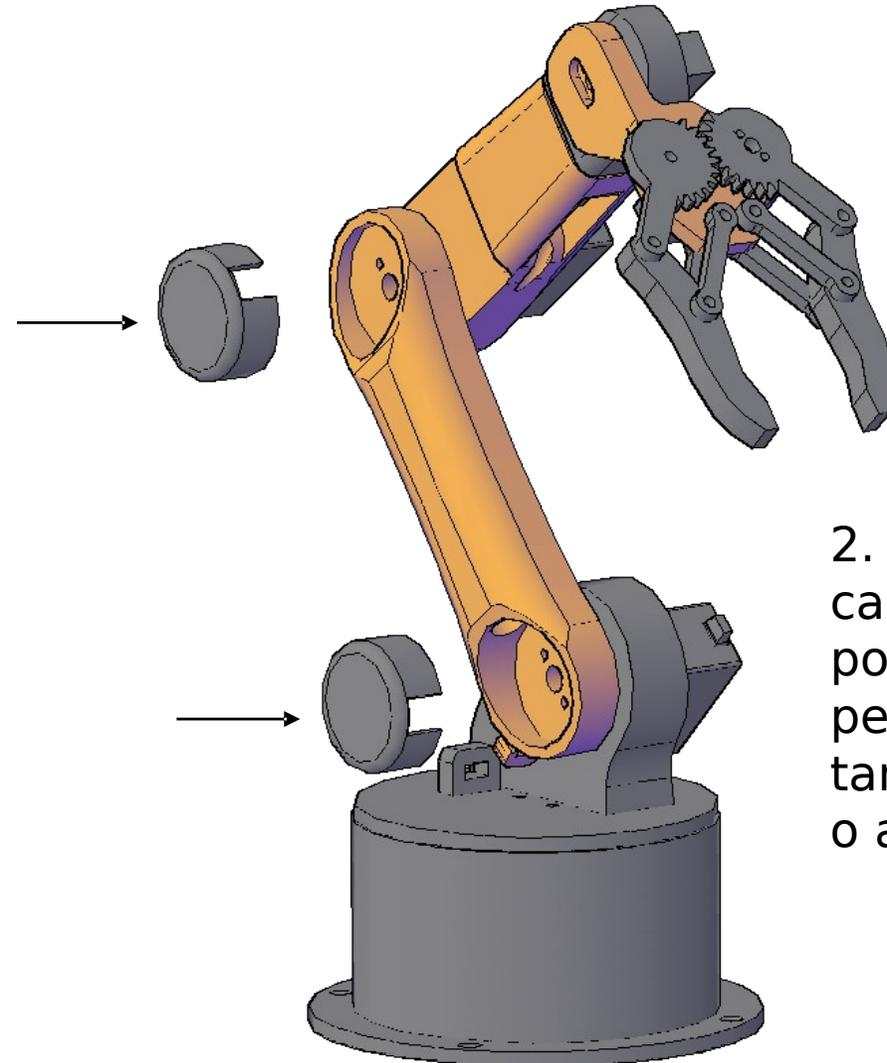
2. Após passar os cabos dos servos por dentro da peça 3 coloque as tampas para dar o acabamento
