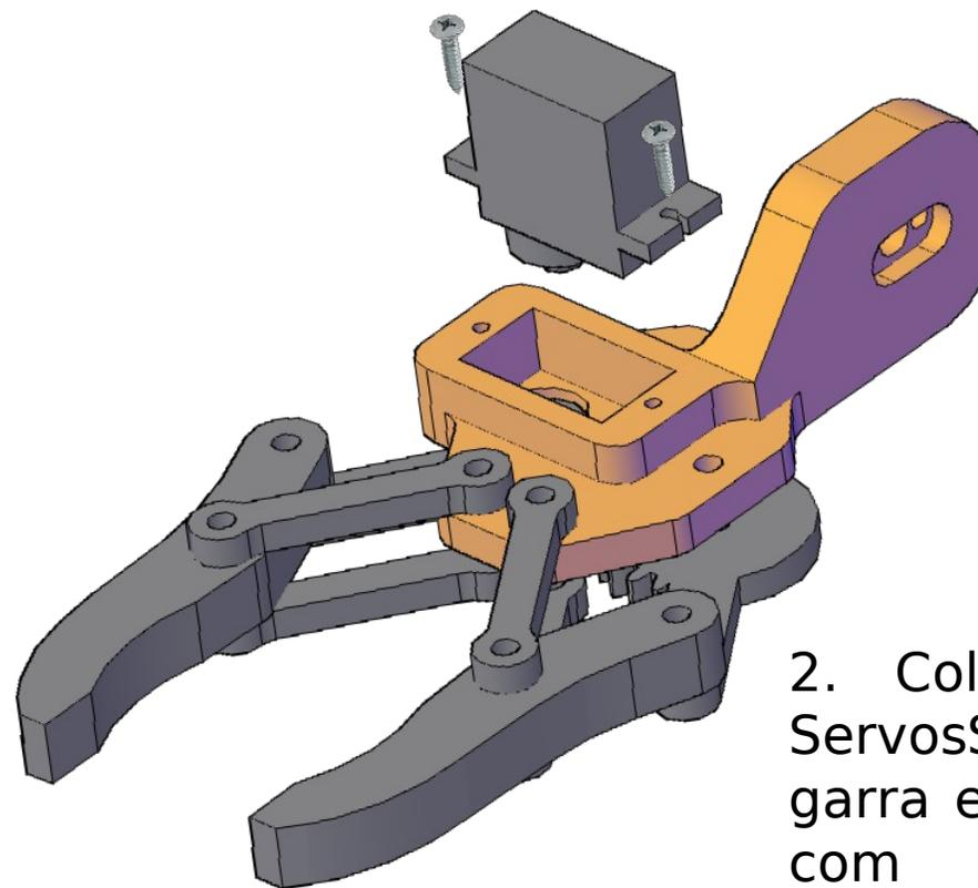
2. Coloque o ServosSG90 na garra e alinhe com as engrenagens da
