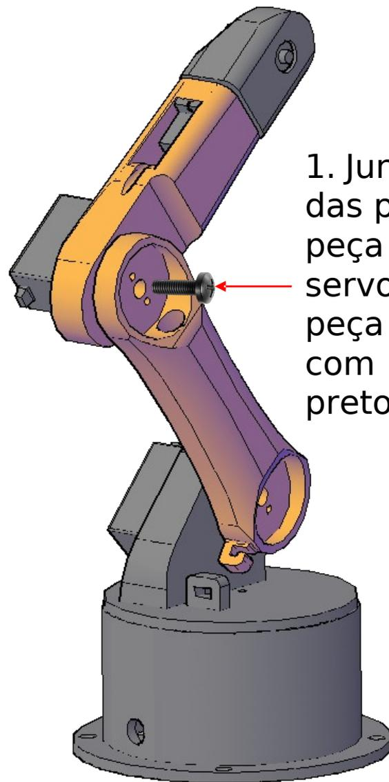
1. Junte o conjunto das peças 5 e 6 na peça 3. Alinhe o servo MG996R da peça 5 e prenda com o parafuso preto do Servo.
