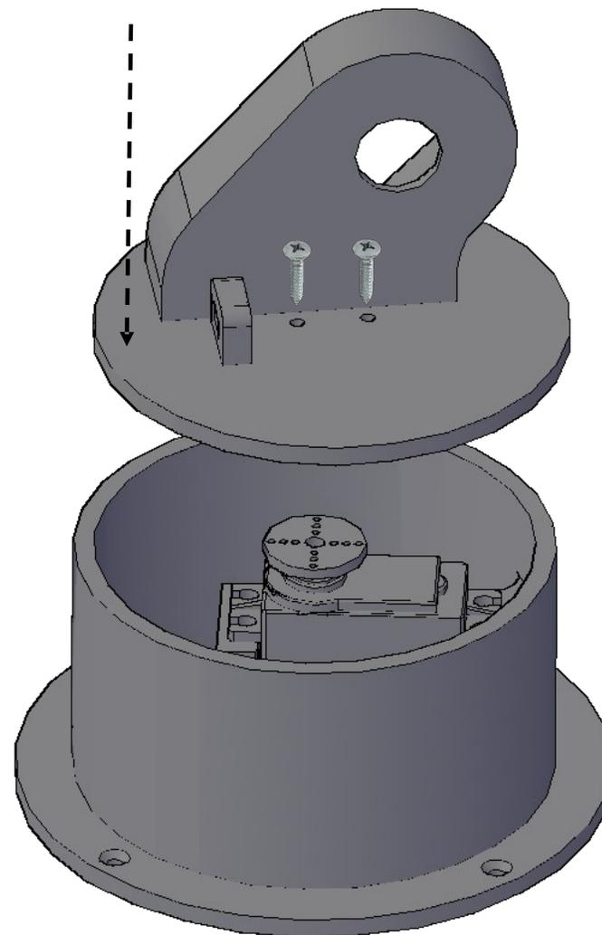
2. Após alinhar o servo coloque a peça 2 no servo da peça 1 e coloque os parafusos do Servo MG996R na engrenagem do servo
