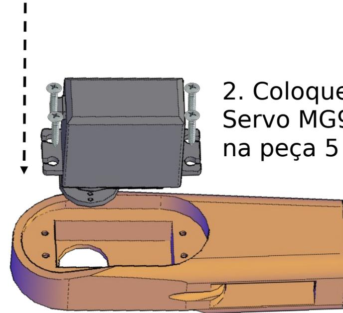
2. Coloque o Servo MG996R na peça 5
