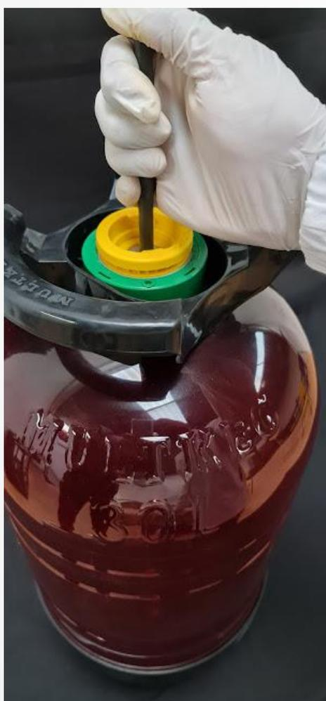
1. Retirar toda a pressão interna do keg com uma ferramenta que não seja pontiaguda para não danificar o pistão de enchimento.
