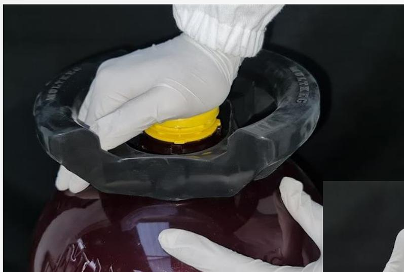
**3.2** Fazer uma leve pressão sobre a válvula para facear as abas da válvula com as abas do keg, eliminando ao máximo o espaço entre válvula e keg.
