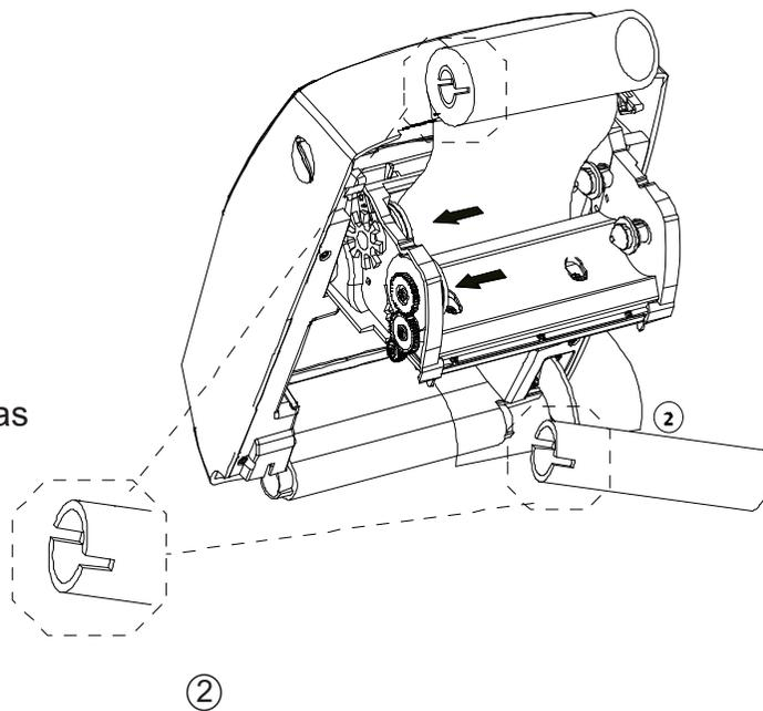
3. Desenrole uns 10cm de Ribbon, e encaixe o rolo nas roldanas de trás. Depois, encaixe o tubete de papelão nas roldanas da frente.
