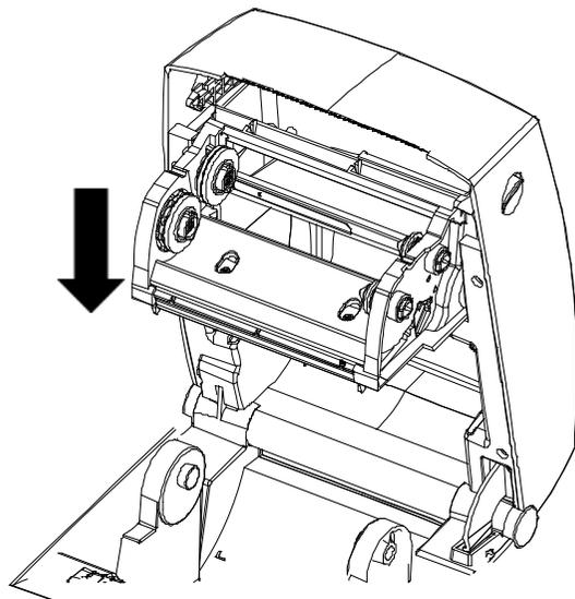
2. Antes de colocar o rolo de Ribbon e o tubete de papelão, note que eles têm cortes, que se encaixam nas roldanas do lado esquerdo.
