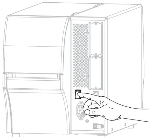
A impressora é inicializada e executa um autoteste. Os resultados do teste são mostrados na Tabela 1. Caso a mídia e a fita estejam carregadas corretamente, a impressora imprimirá uma etiqueta de configuração da impressora (Figura 3) e então uma etiqueta de configuração de rede (Figura 4).
