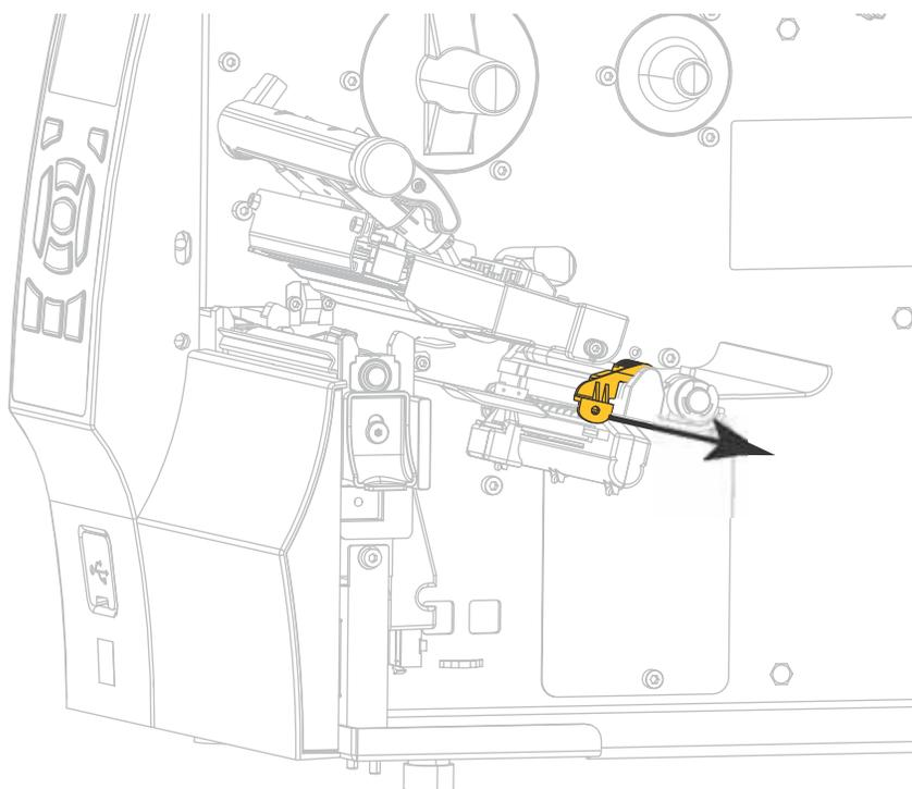
7. Do suporte de mídia (1), insira a mídia sob o rolo oscilante (2), passando pelo sensor de mídia (3) e abaixo do conjunto do cabeçote de impressão (4). Deslize a mídia para trás até tocar na parede interna posterior do sensor de mídia.
