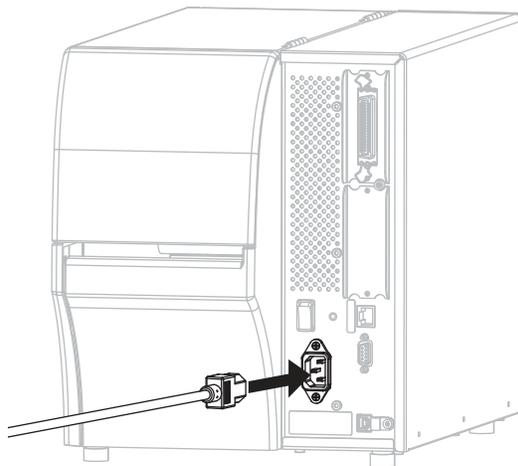
10. Conecte a extremidade macho do cabo de alimentação CA a uma tomada elétrica adequada.
