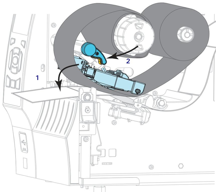
15. Se necessário, pressione PAUSE (PAUSAR) para apagar qualquer erro e ativar a impressão.
