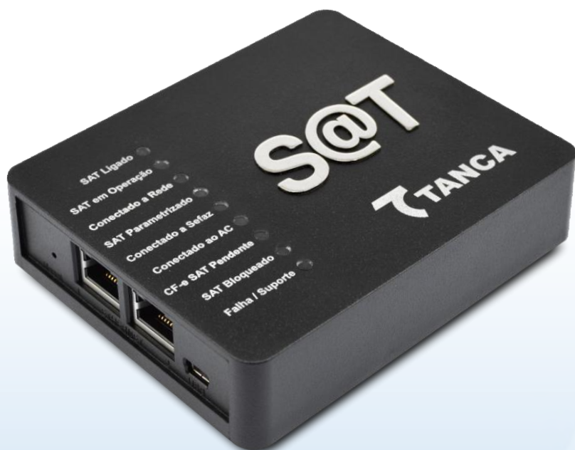
Sistema Autenticador e Transmissor de Cupons Fiscais Eletrônicos
