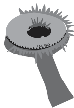
ITEM 3 Chama errada: A chama está fugindo. O queimador engole a chama.
