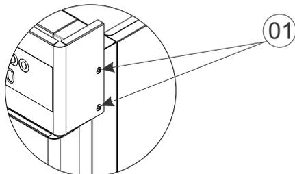
Para instalar a testeira que acompanha o equipamento é necessário afrouxa o (item 01) usando uma chave philips, não é necessário retirar os parafusos. Após afrouxados encaixe a testeira na posição e reaperte os parafusos.
