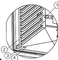
1 Para ajusta o porta esteira e necessário solta o parafuso (item 1) , após solto retirar o porta esteira (item 2), para retirar o porta esteira puxe o mesmo para cima até soltar a parte de baixo, após solto incline em 45° para soltar a parte de cima após isso posicione no pino lateral desejado (item 3, ou item 4), após posicionado encaixe e aperte o parafuso (item 1).
