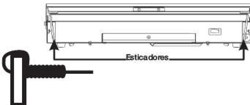
d) Passar o fio por dentro da furação na outra extremidade. Para essa finalização, pressionar o esticador para dentro de forma moderada para que ao soltar ele tensione o fio. Em seguida amarre em torno dele mesmo.
