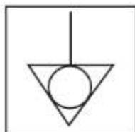
O símbolo indica o terminal de ligação equipotencial, destinado à ligação do equipamento via condutor elétrico a outros pontos de ligação equipotencial, tais como equipamentos, bancadas, edificações, mantendo-se desta forma, o equilíbrio entre diferentes pontos de ligação, minimizando possíveis riscos de choque elétrico.
