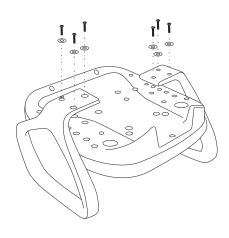
**Passo 03:** Fixar a capa superior do suporte (item 6) ao 'L' do encosto (item 06), utilizar 1 parafuso (item d). Em seguida, encaixar a capa inferior (item 06) e travar o conjunto.
