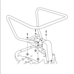
**Passo 06:** Encaixar a capa do encosto (item 01) sobre o 'L' do encosto (item 06), montado no passo 04 e reservar para futura fixação da capa.
