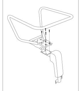
**Passo 05:** Fixar o conjunto montado no passo 04 ao assento do conjunto do passo 02, utilizar 4 parafusos (item e), 4 arruelas (item c) e 4 calços (item g).
