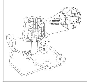
Passo 08: Para finalizar a montagem, posicionar a capa do encosto (item 01), já encaixada no passo 06, sobre o conjunto do encosto (item 02) montado no passo 07 e pressionar os encaixes para fixá-los.
