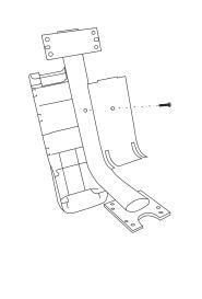
**Passo 04:** Fixar o conjunto de 'L', montado no passo 03, na estrutura fixa (item 07), utilizar 4 parafusos (item h) e 4 arruelas (item c).
