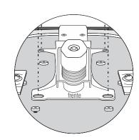
Passo 03: Para finalizar, encaixar sobre o conjunto formado no passo 02, o pistão e o telescópio (item 04), em seguida sobre o pistão encaixar a base com os rodízios (item 05).
