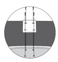
**Passo 02**: Posicionar o mecanismo (item 03) sobre o conjunto montado no passo 01. Fixar com 4 parafusos (item a) + 4 arruelas (item b) + 4 calços (item c)
