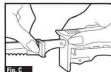
4. Para remover as lâminas faça a operação inversa. Ao mexer nas lâminas, sempre, desligue o aparelho da tomada.
