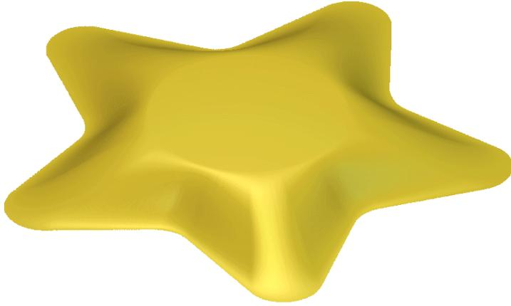
Um relevo suave é produzido do vetor **externo** para o vetor **interno**. Ele então continua com altura constante (5mm) na área interna do vetor **interno**.
