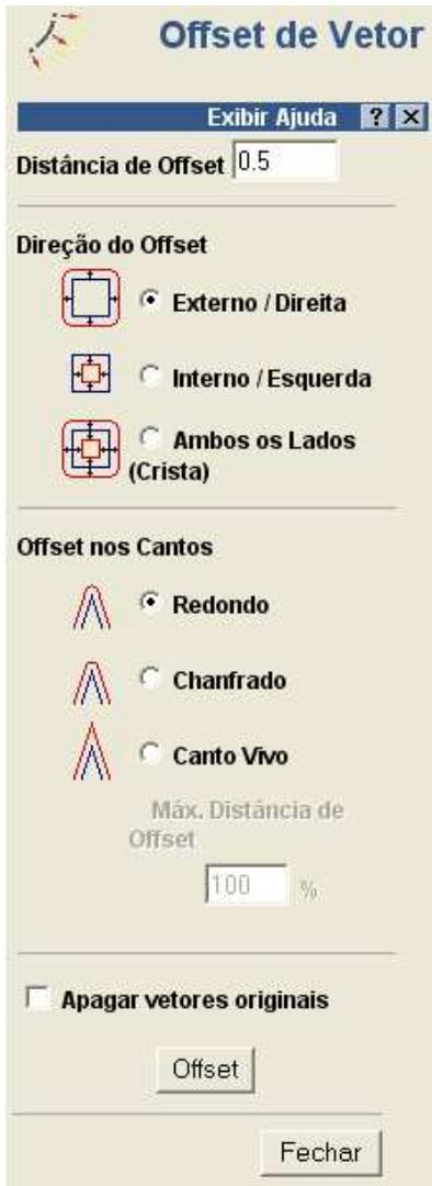
O formulário de offset de vetor aparece no assistente. Vetores podem sofrer offset para dentro, para fora ou ambos e podem, nas junções entre linhas retas, receber um chanfro ou raio.
