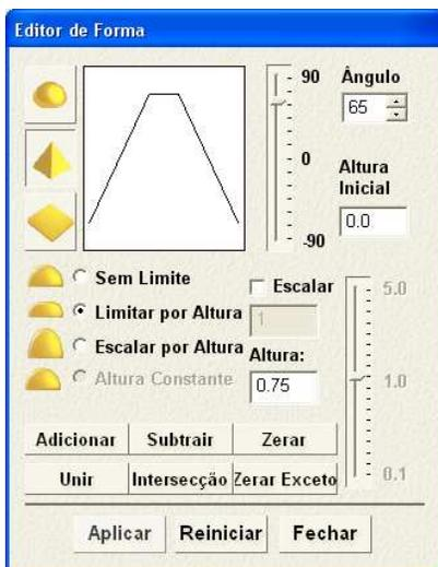
Ao vetor foi atribuída uma forma piramidal, com ângulo de inclinação de 65 graus até alcançar a altura de 0.75mm, onde permanece plano.
