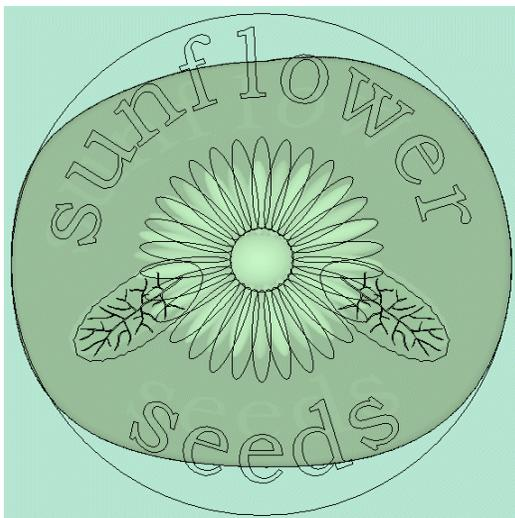
Quando o relevo é alterado a vista em escala de cinza é automaticamente atualizada. Ativando a vista **Nível de Relevo** você pode visualizar a diferença do projeto de vetor original.
