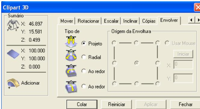
Há quatro formas de envolver, **Projeto** (padrão), **Radial** (para corpos arredondados), **Ao redor de X** e **ao redor de Y**. A origem do envoltório também pode ser configurada. .
