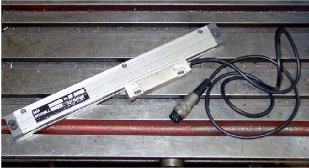
Figura 4-15: Encoders com Escalas de Vidro
