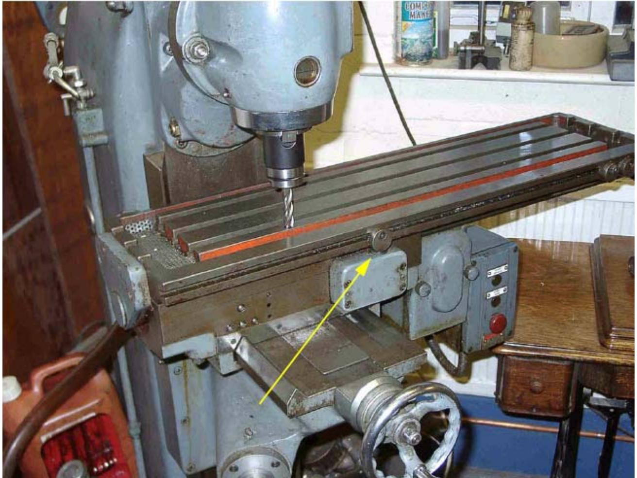
Figura 4-10: Ferramenta em X=0, Y=0, Z=0 (note o cão está no limite do interruptor)
