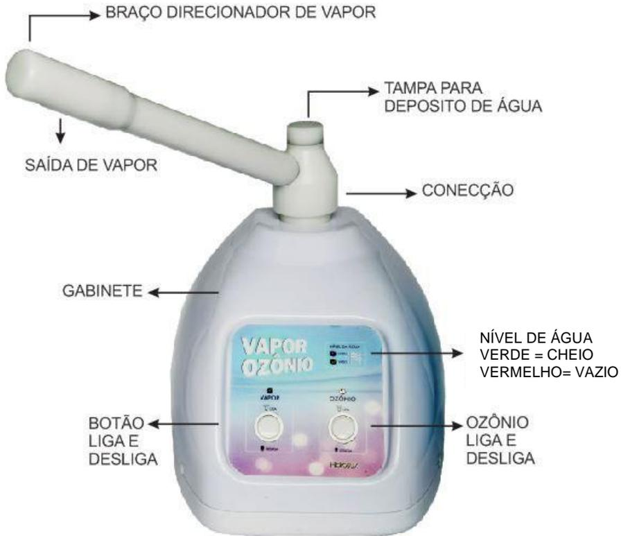
**Atenção:** Para maior facilidade no transporte do equipamento o braço direcionador do vapor está desmontado, desconectado do corpo do aparelho. Ao retirar o equipamento da caixa de transporte, você deverá primeiro conectar o braço direcionador. ENCAIXAR COM FIRMEZA O BRAÇO FAZENDO COM QUE OS ANEIS DE BORRACHA ENTREM NA CONEXÃO EXISTENTE NO CORPO DO APARELHO. ROSQUEAR E APERTAR O ANEL DE VEDAÇÃO.
