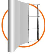
8- Encaixe a parte chanfrada da lamina no parafuso superior da estrutura fixando o imã na régua faça isso com a estrutura em pé
