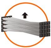
2- Abra a estrutura segurando na parte de cima levando para cima de forma que fique totalmente aberta.
