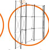
7- Com as réguas instaladas comece a aplicação das laminas pela parte superior e da esquerda para a direita.
