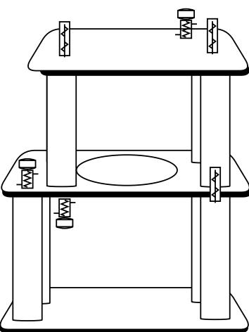
Agora coloque os **4 postes** de 36cm (**figura B**) dois serão presos com os parafusos sem cabeça e outros dois serão presos com parafusos com cabeça na parte de baixo, conforme imagem. Usando a plataforma da **figura F**. Fixe mais três parafusos sem cabeça e um parafuso com cabeça
