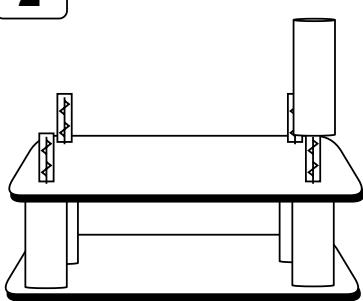
Depois siga a imagem do produto e fixe dois parafusos (**figura J**) sem cabeça nos postes ao qual o produto ficará no fundo. Adicione a plataforma da **figura E**. Dois furos serão fixados no poste com parafusos com cabeça
