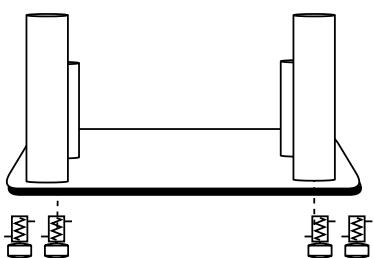
Utilize os **4 postes** de 46cm (**figura A**) na plataforma da **figura D**. Use sua chave para fixar nos parafusos com cabeça (**figura I**)
