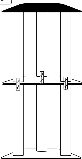
Aperte bem os postes (A) entre as plataformas (C), travando-os para garantir a melhor fixação entre as bases.
