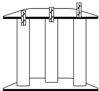
Fixe os parafusos (J) em uma plataforma (C) que possui três furos centrais, além dos furos para fixar a redinha espriguiçadeira
