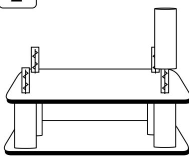
Depois do passo 1, coloque 4 parafusos sem cabeça (F) nos furos. Aperte os quatro postes de 46 cm até travar. Coloque mais 4 parafusos sem cabeça em cima e coloque a plataforma com o círculo.
