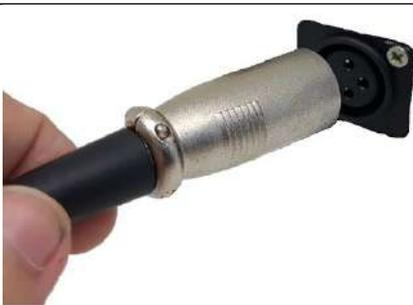
Passo 1 - Conecte o plug de carregamento do carregador no conector da bateria do KIT LIVRE®.
