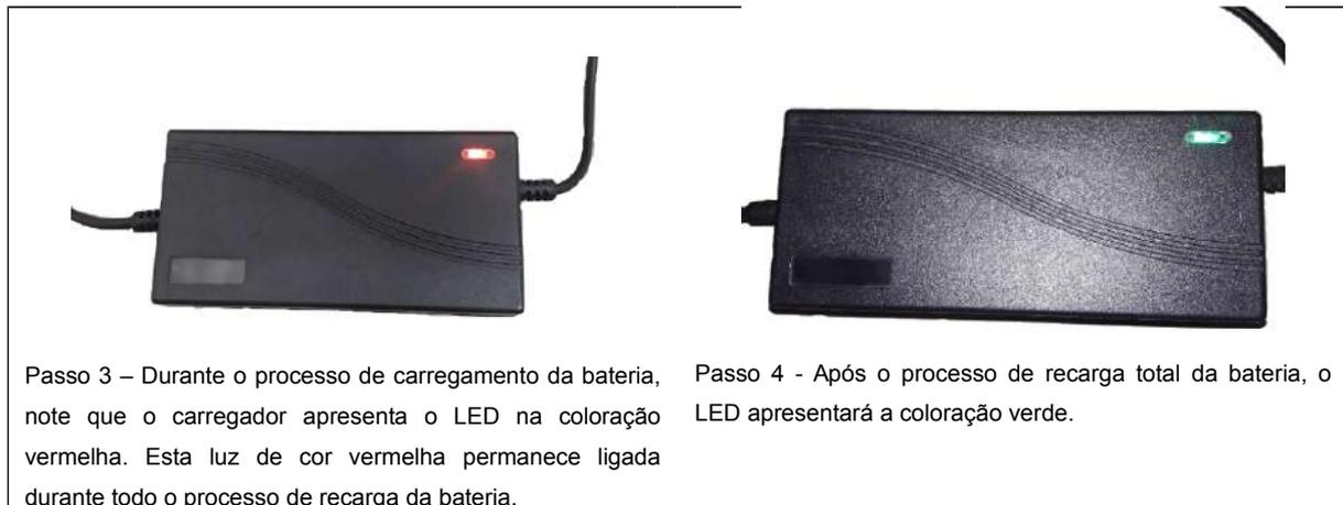
Figura 12 – Processo de recarga da bateria do KIT LIVRE®.
