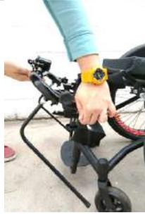
Passo 2: Desarmar os acoplamentos laterais (17,18) e levantar o suporte.
