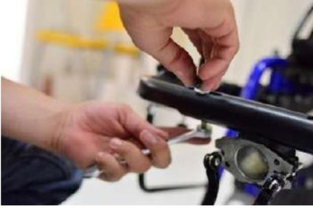
Passo 13: Inserir as porcas dos parafusos (23,25) no centro do suporte (8) e realizar o aperto. Utilizar as chave Allen 6 mm (11) e combinada 13 mm (16).
