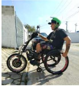
Figura 33 - Subida de calçadas com o KIT LIVRE® com auxílio de propulsão na roda traseira – \* Imagem meramente ilustrativa.
