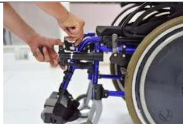
Passo 8: Instalar o acoplamentos laterais (2,17,18).
