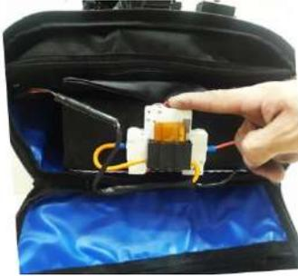
Passo 1 - Desligue a Chave disjuntora de segurança.
