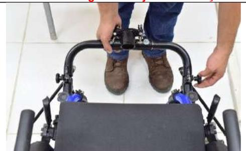
Passo 12: Apertar os manípulos de ligação (27) dos acoplamentos laterais (17,18).
