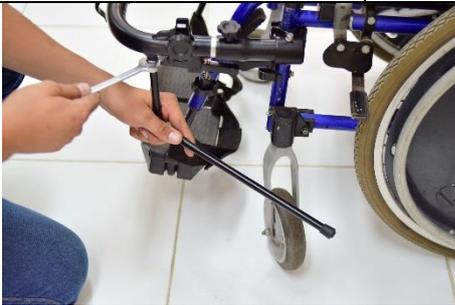
Passo 16: Verificar o posicionamento dos cavaletes (4) e apertar as porcas. Utilizar a chave combinada 5/8”(15).
