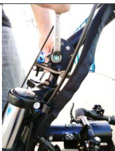
Passo 10: Apertar o parafuso M8 da coluna de direção do KIT LIVRE®. Utilizar as **chave Allen 6 mm (11) e combinada 13mm (16).**
