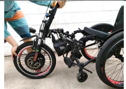
Passo 6: Levantar o KIT LIVRE® para travar os acoplamentos laterais (17,18).
