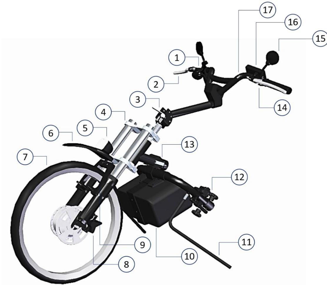
Figura 5 - Componentes do KIT LIVRE® Chopper 1000W – \* Imagem meramente ilustrativa.
