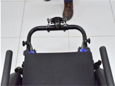
Passo 13: Inserir as porcas dos parafusos (23,25) no centro do suporte (8) e realizar o aperto. Utilizar as chave Allen 6 mm (11) e combinada 13 mm (16).
