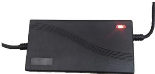
Passo 3 - Durante o processo de carregamento da bateria, note que o carregador apresenta o LED na coloração vermelha. Esta luz de cor vermelha permanece ligada durante todo o processo de recarga da bateria.
