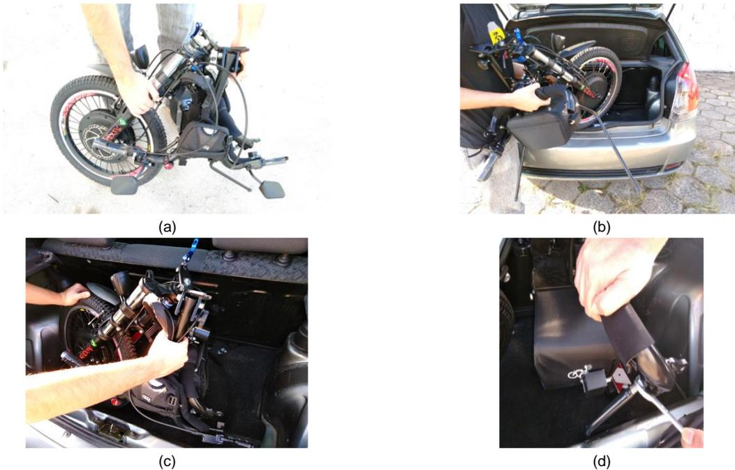
Figura 44 – Armazenamento do KIT LIVRE® no porta-malas em veículo compacto modelo Hatch: (a) KIT LIVRE® dobrado; (b) colocar no porta-malas; (c)acomodar o KIT LIVRE®; (d) afrouxar o cavalete do suporte, caso necessário e reapertar em seguida – \* Imagem meramente ilustrativa.
