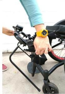
Passo 2: Desarmar os acoplamentos laterais (17,18) e levantar o suporte.
