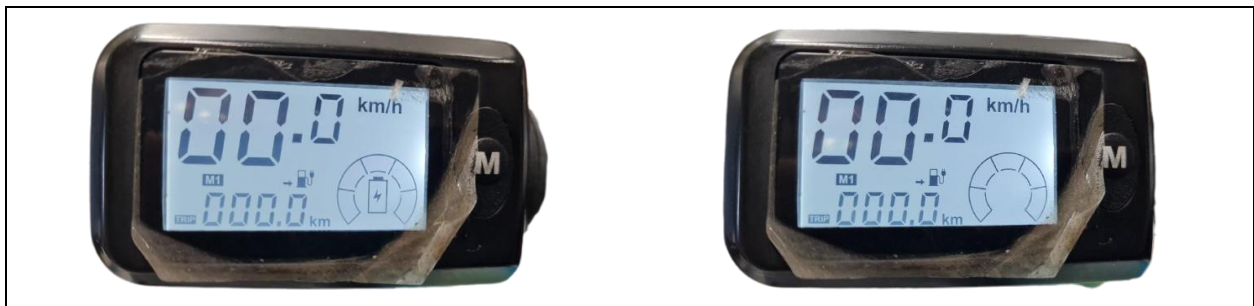
Figura 23 - Indicador de baixa bateria piscando e ícone de necessidade de recarga de bateria.
