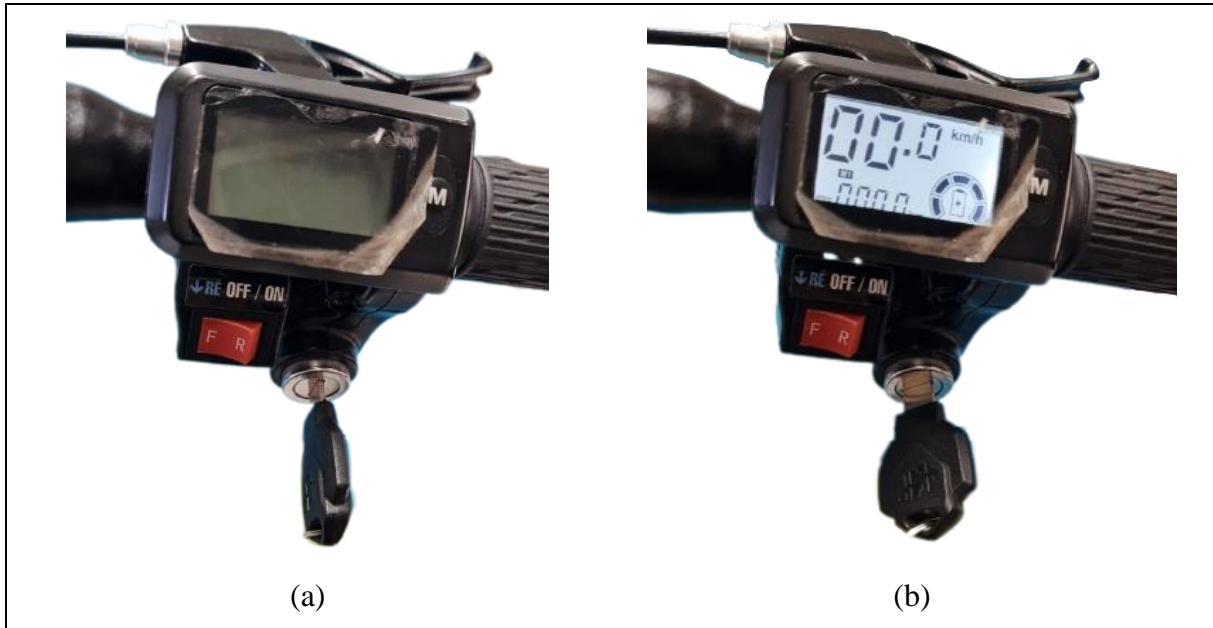
Figura 20 - Display LCD10 com chave: (a) Desligado; (b) Ligado.
