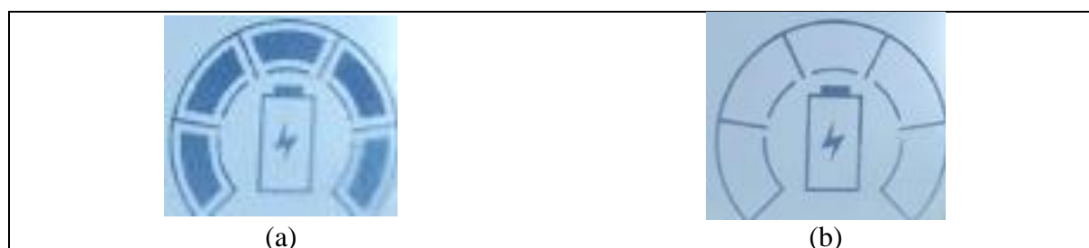
Figura 24 - Indicador do nível de bateria: (a) Bateria completamente carregada; (b) Bateria descarregada.
