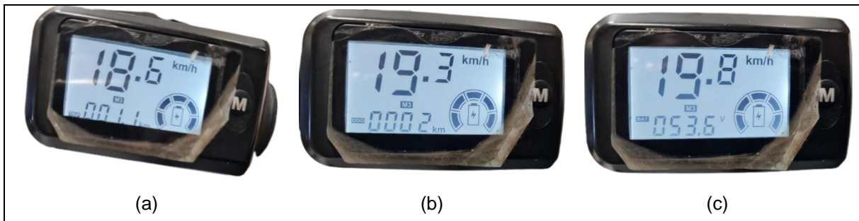
Figura 17 – Informação no Display LCD9: (a) Distância do Percurso Atual (TRIP); (b) Distância total percorrida (ODO); (c) Voltagem da bateria (BAT).
