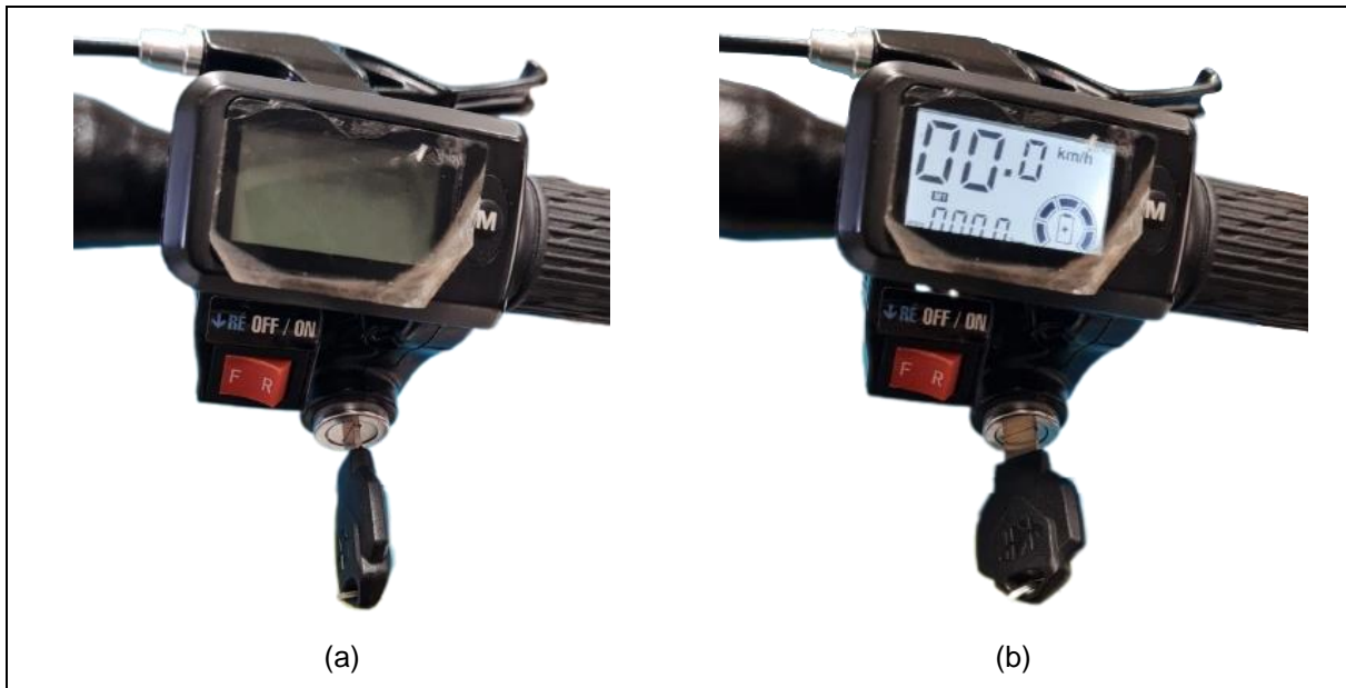
Figura 15 - Display LCD9 com chave: (a) Desligado; (b) Ligado.
