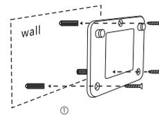
1. Fixe os 3 parafusos na parede
