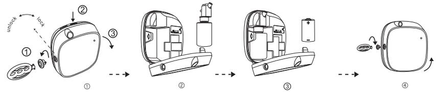
1. Insira a chave e a peça de encaixe, gire para "destravar" e puxe-as para fora. Pressione o botão fixo na parte superior e empurre para frente.
