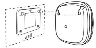
2. Pendure a máquina nos parafusos
