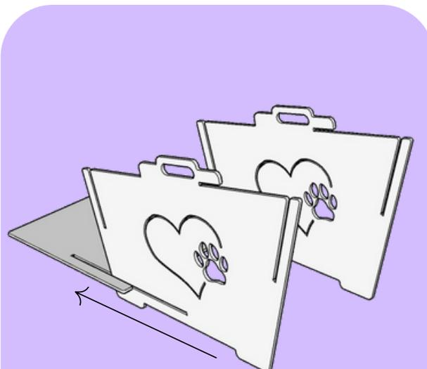
Encaixe as laterais na base, deslizando conforme imagem acima.
