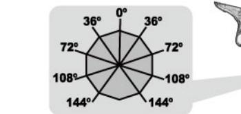
10-SIDE PLUG CAN PROVIDE 9 DIFFERENT ANGLES ON THE LEFT AND RIGHT.
