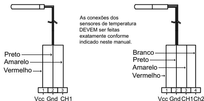
As conexões dos sensores de temperatura DEVEM ser feitas exatamente conforme indicado neste manual.
