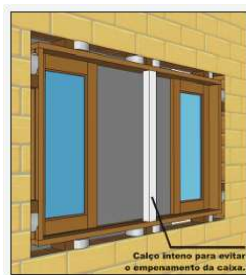
FIGURA 3 - DETALHE DO CALÇO INTERNO PARA EVITAR O EMPENAMENTO DA ESQUADRIA PELA PRESSÃO DA ESPUMA
