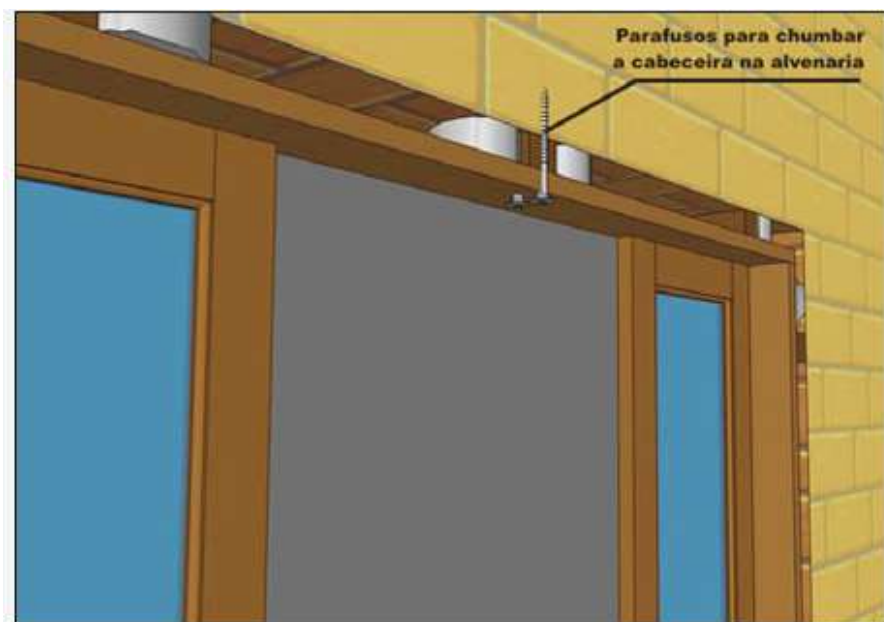
FIGURA 5 - PARAFUSOS PARA CHUMBAR A CABECEIRA NA ALVENARIA
