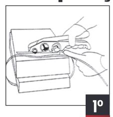
Coloque a fita em volta da embalagem, aperte o esticador e insira a fita sob a abraçadeira e a cobertura externa do cortador, o final da fita deve ultrapassar 10 cm da área de corte;
