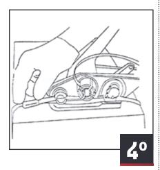
Assim que a fita estiver tensionada, coloque o grampo na área em que o final e o começo da fita se encontram;
