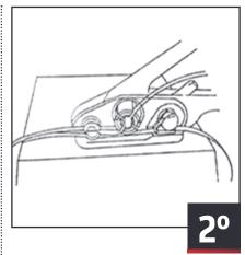
Passe a fita dentro do cortador e do tensionador conforme mostra a imagem;
