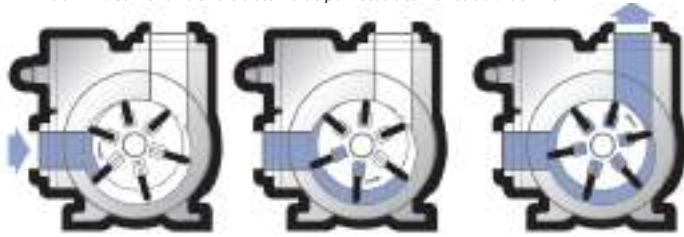
FIGURA 1. Como funciona o sistema de palhetas deslizante da Blackmer
