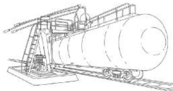
Sistema de recuperação de vapor (tanque / trem)
