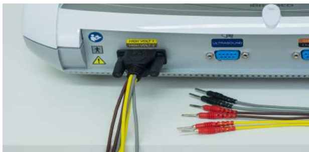
Imagem 32. Conexão do cabo de eletroestimulação (amarelo, marrom e cinza) com extremidade pino banana para a corrente High Volt.
