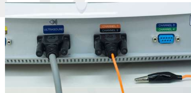
Imagem 31. conexão para a terapia combinada ultrassom + corrente Polarizada.
