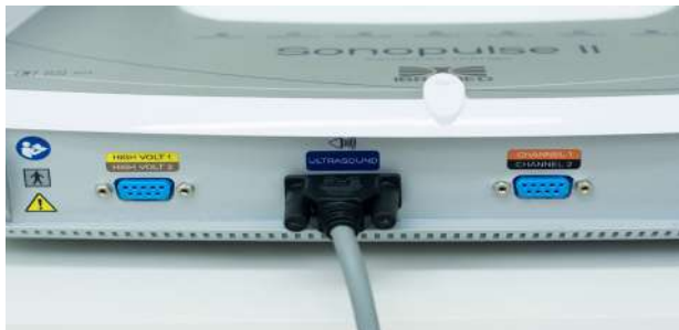
Imagem 28. Conexão do cabo do transdutor do ultrassom.
