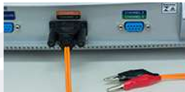
Imagem 34. conexão do cabo de eletroestimulação laranja/preto com extremidades garra de jacaré.
