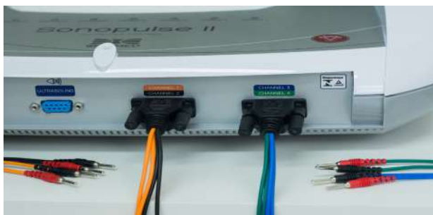
Imagem 35. conexão do cabo de eletroestimulação laranja/preto e azul/verde com extremidades pino banana.
