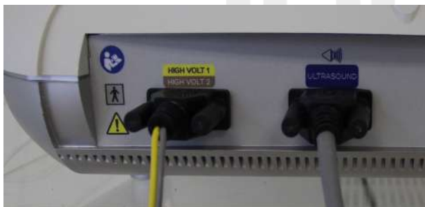
Imagem 29. conexão para a terapia combinada ultrassom + corrente High Volt.
