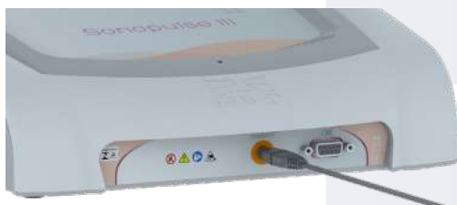
Imagem 6. Conexão do cabo de terapia combinada no equipamento.
