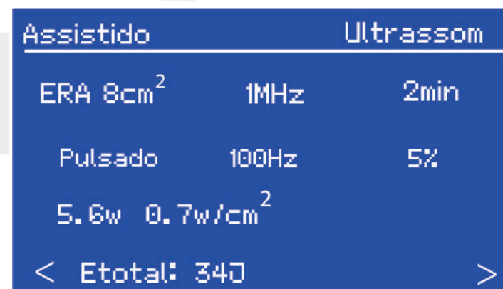
Imagem 44. Tela com resumo com os parâmetros programados automaticamente pelo equipamento.
