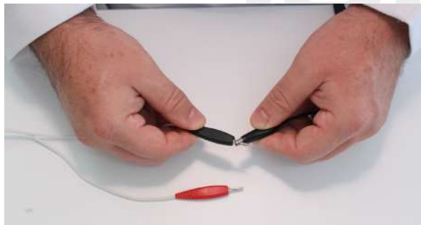
Imagem 7. Conexão do pino banana preto a garra jacaré.
