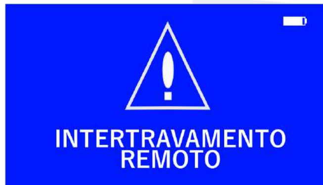
Imagem 47. Tela de intertravamento remoto acionado.
