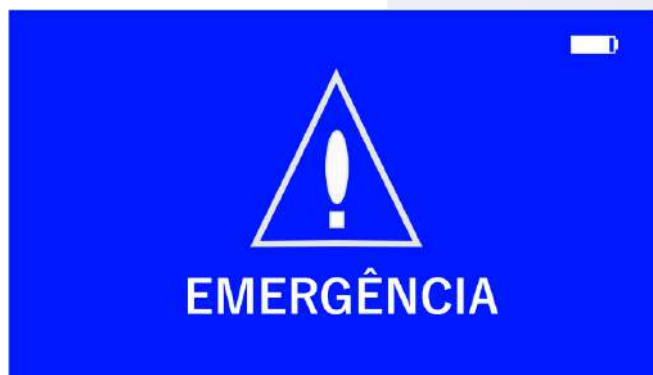
Imagem 46. Tela de botoeira de emergência acionada.
