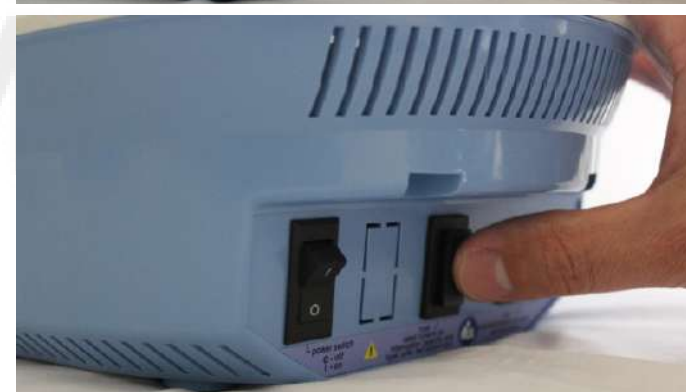
Figura 13. A , abrindo a caixa de fusível; B , removendo a gaveta da caixa de fusível; e C , reposicionando a gaveta da caixa de fusível.
